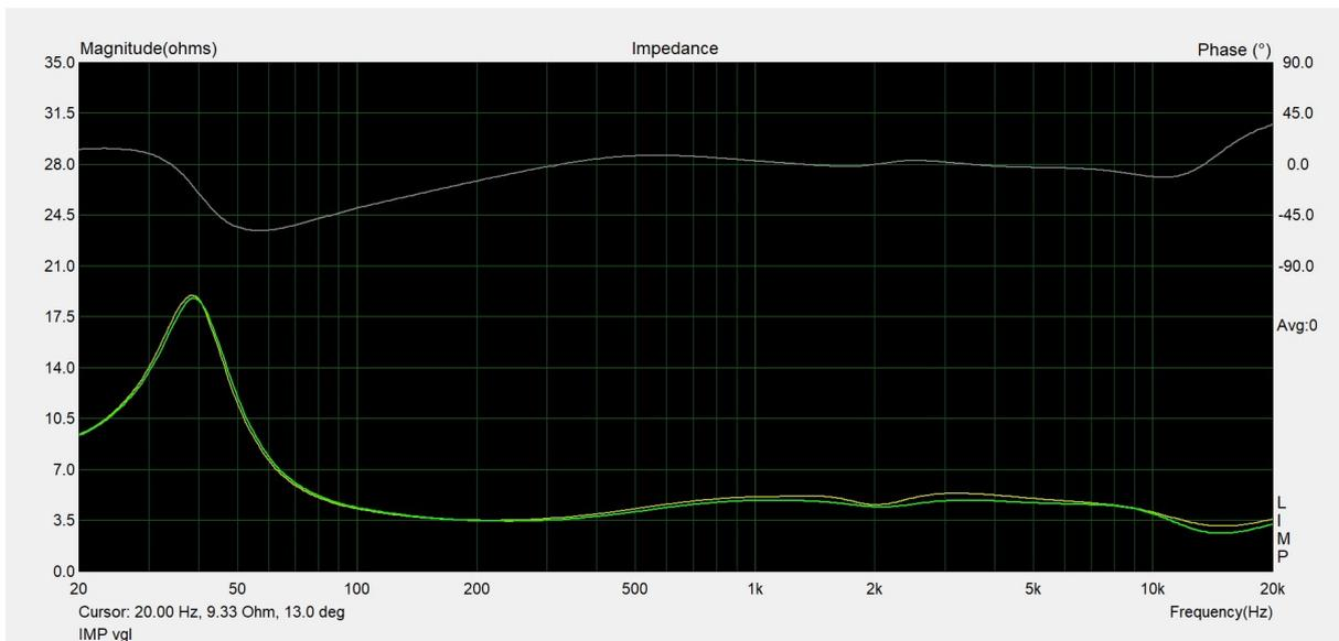
Die Impedanz fällt im Bereich um 200hz auf 3,2 Ohm ; bei Röhrenverstärkern ist daher der 4 Ohm Ausgang zu wählen.
