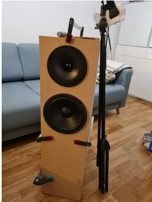
Fullrange 2 Wege System mit dem Hochtöner Monacor DT-300 (ferrofluidbefreit) im Waveguide WG-300 und dem Sica Tieftöner 8H2CP. Kosten pro Box für Chassis und Weiche ca. 230€. Hinzukommen noch Dämmmaterial, Terminal, Kabel, Schrauben, Füße etc...
