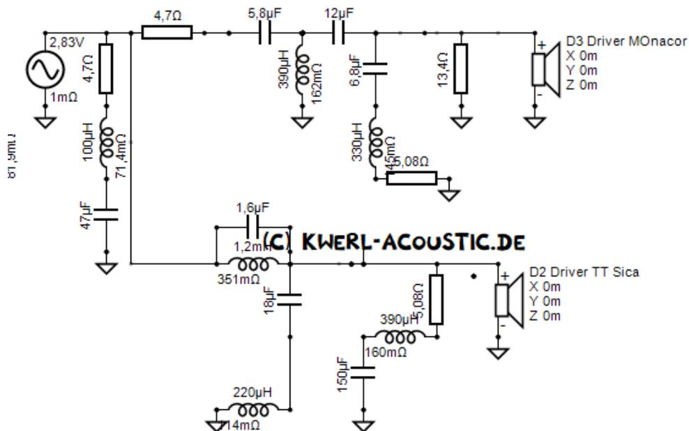
Die Weiche besteht im Hochpass aus einem 18db Filter mit Spannungsteiler und Entzerrung. Der Spannungsteiler kann mit den Werten zwischen 10 und 15 Ohm den Hochtöner im gesamten um +/-3 db ändern. Bei ca. 12,5 Ohm ist der Verlauf linear. Im 18db Filter sind MKP-Kondensatoren empfohlen.
