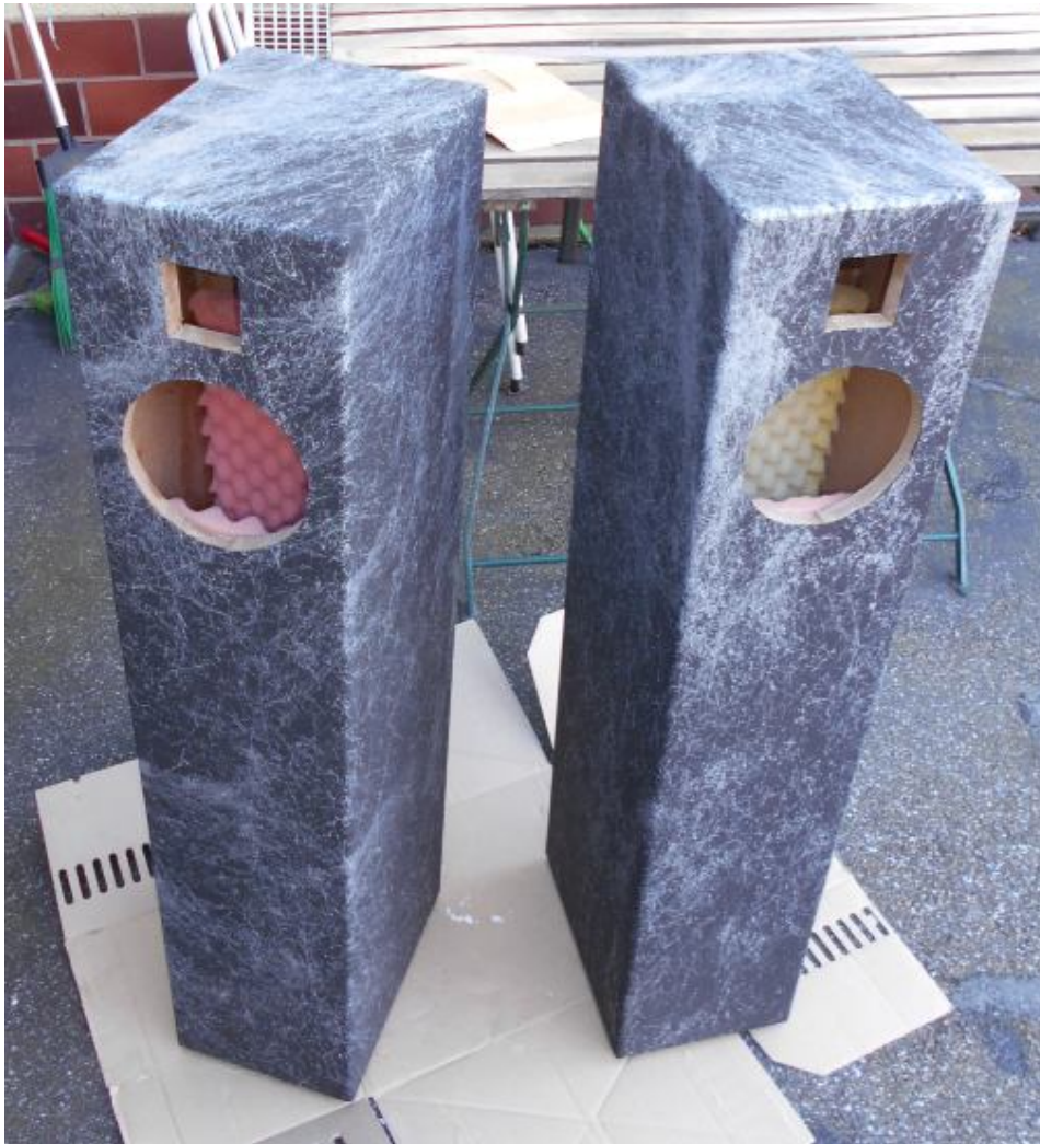
Löcher für Anschlussport gesägt
